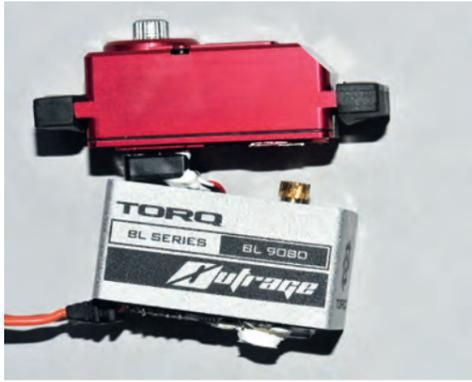
Das Servopot des BL9080 ist direkt am Getriebekasten verklebt, das Getriebe ist aus Stahl
