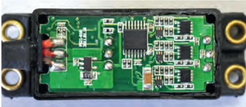
Alle smd-bestückten Elektronikplatinen – hier als Referenz das Graupner HBS-790 – sind direkt mit den BL-Triebwerken verlötet und zusätzlich noch mit zähelastischem Klebstoff gesichert. Das Gleiche gilt für alle Verbindungen zu den Servopotis
