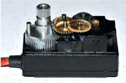
Das HBS-790 hat als besonders flach bauendes Servo ein fünfstufiges Getriebe
