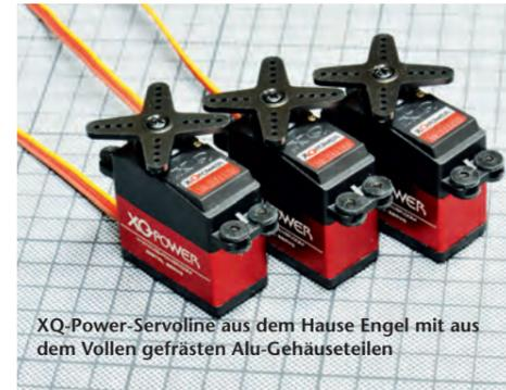
XQ-Power-Servoline aus dem Hause Engel mit aus dem Vollen gefrästen Alu-Gehäuseteilen
