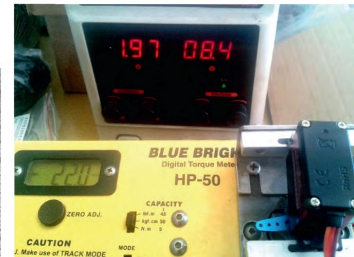
Typischer Messaufbau mit Torque-Meter nach asiatischer Methode. Vom Kupplungskreuz geht die eingeleitete Kraft über hoch unteretzte Hebelmechaniken direkt auf Drucksensoren. Strom, Spannung und Torque mit Maximalstrom = Blockierstrom können direkt abgelesen werden
